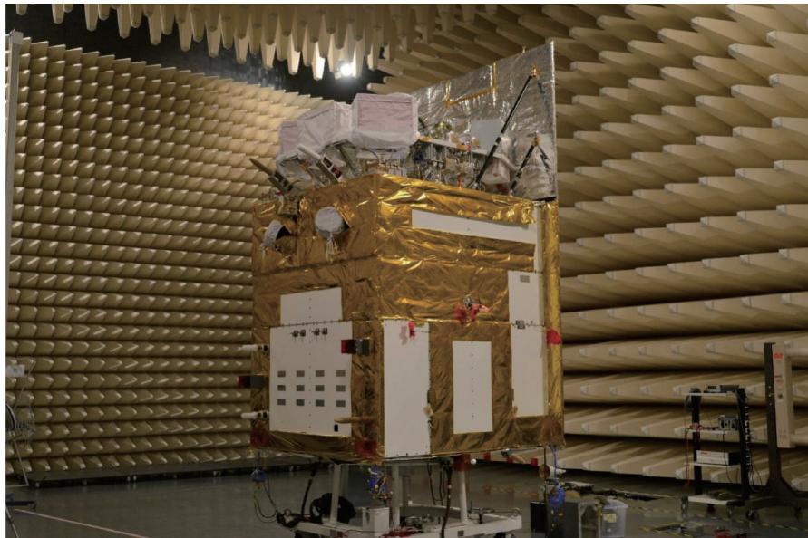
图3 HXMT卫星正样星电磁兼容性实验
