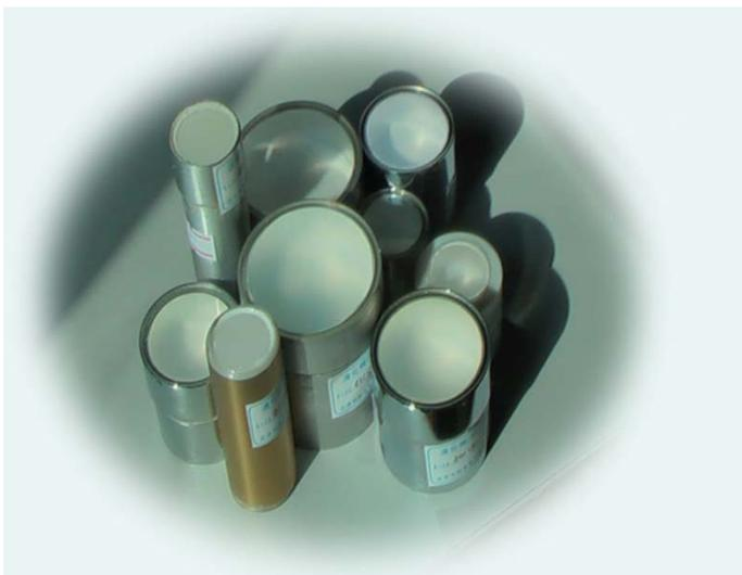
LaBr3(Ce)闪烁晶体具有光产额高、能量分辨率好、衰减时间短、非线性响应小等优点，可广泛应用于核物理研究，以及国际反恐反恐、核材料控制、安全检查、能源、核医学、工业计量、石油测井等多个领域。
