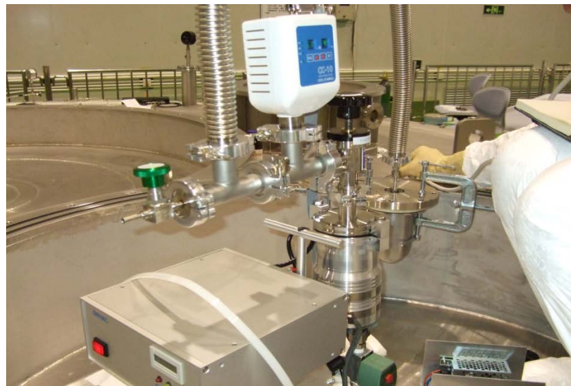
图 钢盖上设备的检漏
